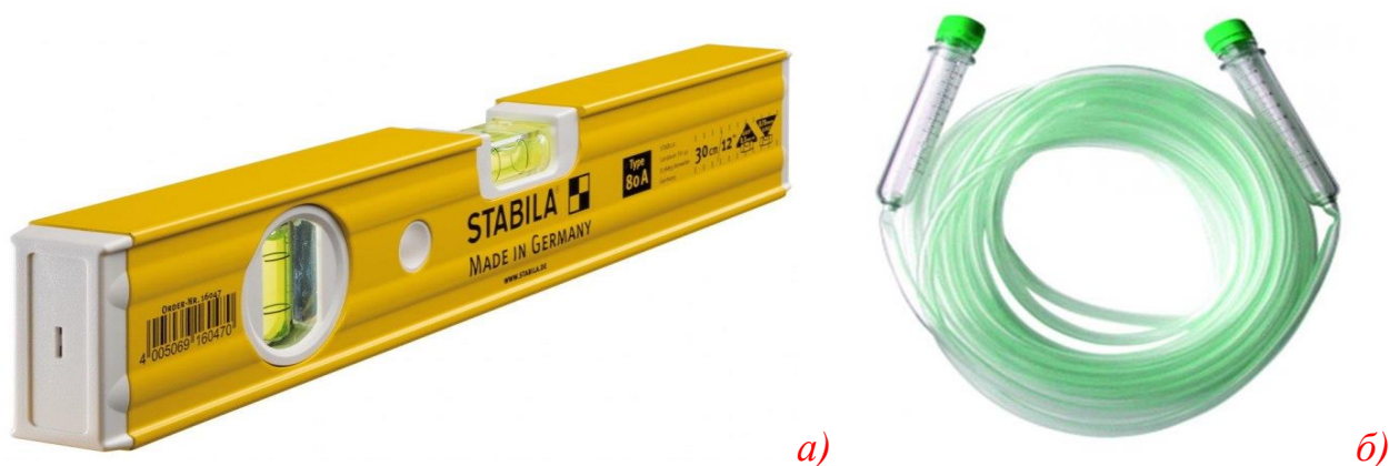
Рис. 2. Уровни: а — с воздушным пузырьком (прямой); б — водяной
