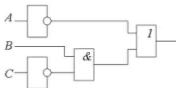
Определить, какое значение (истина или ложь) будет на выходе схемы, если известны значения на ее входах:  $A=0$ ,  $B=1$ ,  $C=1$ .
