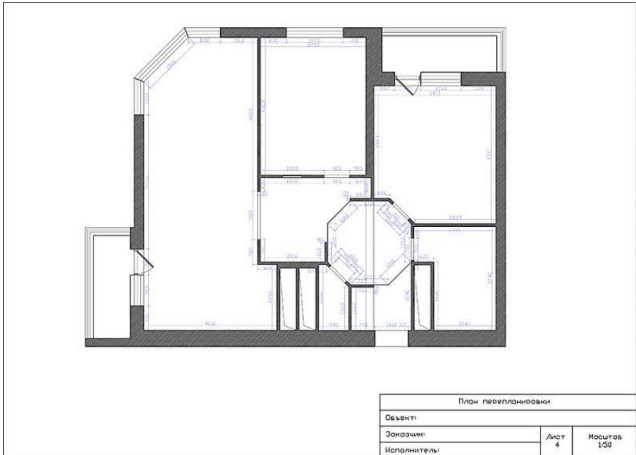
Планы по сносу и возведению стен совмещаются. В результате составляется чертеж с итоговым расположением стен и перегородок.
