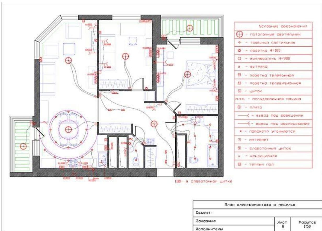
Чертеж совмещает план расстановки мебели и схему расположения электроприборов. Он наглядно показывает, как совмещается обстановки, бытовая техника и освещение.
