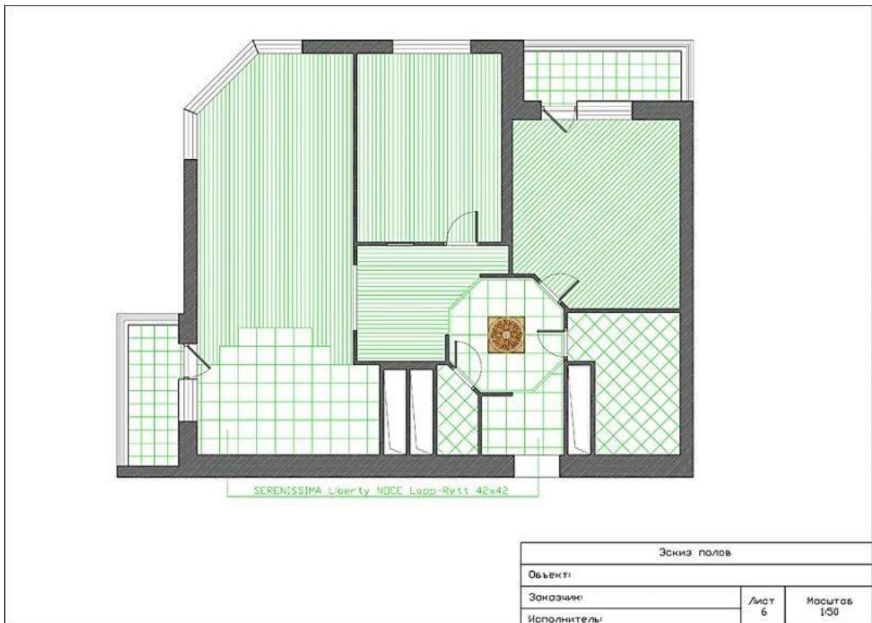
Показывает, какой тип покрытия будет использоваться в помещениях. На чертеже должно быть указано начало направления раскладки, высота подиумов. Размечаются стыковые элементы, рассчитывается площадь покрываемой поверхности.
