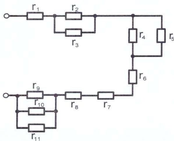
$r_1 = 2 \text{ Ом}; r_2 = 1.3 \text{ Ом}; r_3 = 5 \text{ Ом}; r_4 = 7 \text{ Ом}; r_5 = 3.7 \text{ Ом}; r_6 = 10 \text{ Ом}; r_7 = 9 \text{ Ом}; r_8 = 11 \text{ Ом}; r_9 = 9 \text{ Ом}; r_{10} = 3 \text{ Ом}; r_{11} = 40 \text{ Ом} .$
