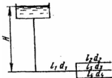
Задача 7. В баке, имеющем в дне отверстие диаметром  $d_1 = 100$  мм и в стенке отверстие, снабженное цилиндрическим насадком, диаметром  $d_2 = 75$  мм; установлены уровень воды на высоте  $H = 1,8$  м (см. рис.). Определить, какой расход воды  $Q$  поступает в бак, если центр бокового отверстия возвышается над дном бака на высоту  $h = 0,4$  м.
