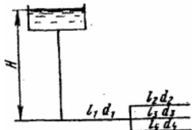
Задача 7. В баке, имеющем в дне отверстие диаметром  $d_1 = 100 \text{ мм}$  и в стенке отверстие, снабженное цилиндрическим насадком, диаметром  $d_2 = 75 \text{ мм}$ ; установился уровень воды на высоте  $H = 1,8 \text{ м}$  (см. рис.). Определить, какой расход воды  $Q$  поступает в бак, если центр бокового отверстия возвышается над дном бака на высоту  $h = 0,4 \text{ м}$ .
