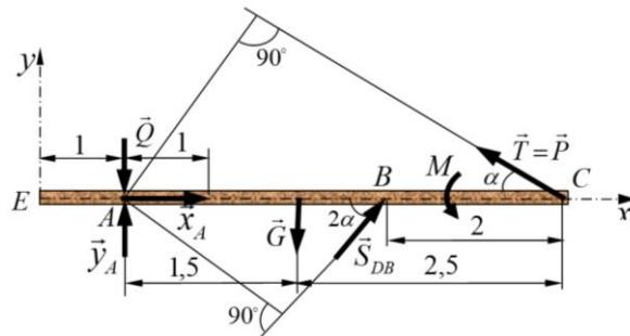
Данная конструкция (балки) под действием активных сил и сил реакций (произвольно плоская система сил) находится в состоянии равновесия. Составляем уравнения (условия) равновесия данной системы сил, с учетом системы координат.
