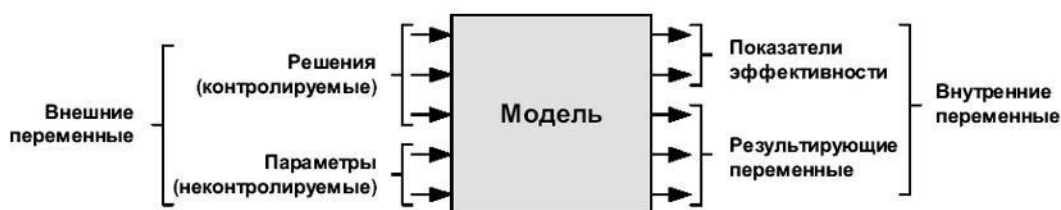
Рис.1. Модель, построенная по принципу «черного ящика»
