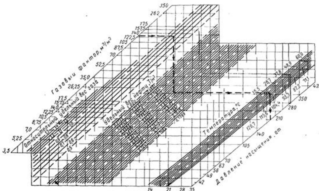
Рис. 1. Номограмма М. Стендинга для определения давления насыщения.
