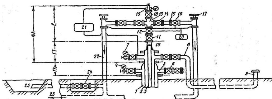
Схема оборудования устья скважины крестовой арматурой: ГК - головка колонная; ГТ - головка трубная; Е - елка; ФА- фонтанная арматура;
