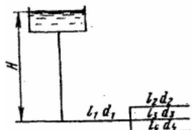
Задача 7. В баке, имеющем в дне отверстие диаметром  $d_1 = 100$  мм и в стенке отверстие, снабженное цилиндрическим насадком, диаметром  $d_2 = 75$  мм; установлен уровень воды на высоте  $H = 1,8$  м (см. рис.). Определить, какой расход воды  $Q$  поступает в бак, если центр бокового отверстия возвышается над дном бака на высоту  $h = 0,4$  м.
