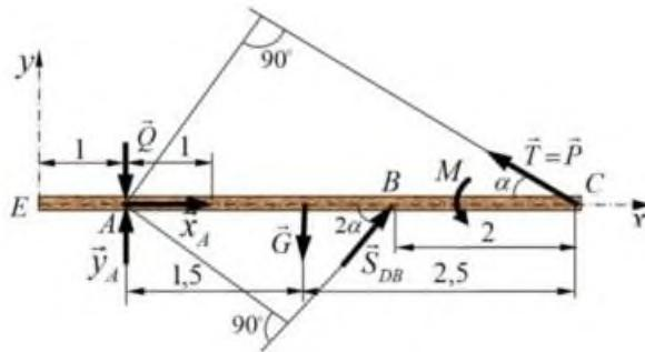
Данная конструкция (балки) под действием активных сил и сил реакций (произвольно плоская система сил) находится в состоянии равновесия. Составляем уравнения (условия) равновесия данной системы сил, с учетом системы координат.
