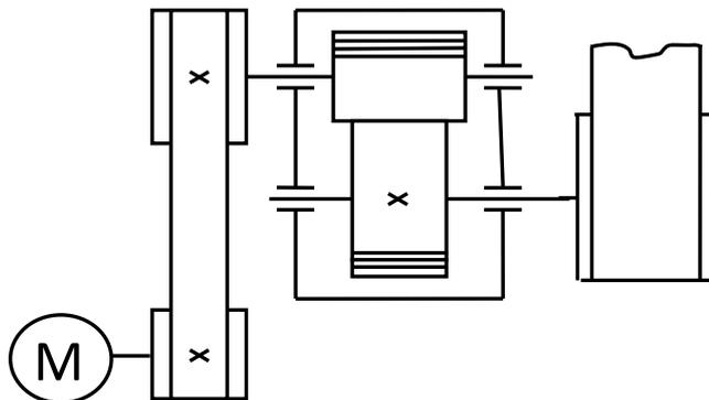
5. Лента транспортера, имеющая максимальную тяговую силу 10кН, перемещается со скоростью 1,5м/с. Определить требуемую мощность электродвигателя, если общий к.п.д. составляет 0,845.
