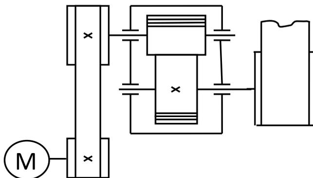
5. Определить силу, от воздействия ремней клиноременной передачи, действующую на валы, если известна сила предварительного натяжения ремней 850Н, и угол обхвата ремнём меньшего шкива  $120^\circ$ .
