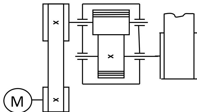
5. Определить силу, от воздействия ремней клиноременной передачи, действующую на валы, если известна сила предварительного натяжения ремней 850Н, и угол обхвата ремнём меньшего шкива 120°.
