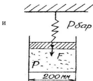
5. Цилиндр диаметром  $200 \text{ мм}$  плотно закрыт подвешенным на пружине поршнем, условно невесомым скользящим без трения. В цилиндре образован вакуум, составляющий  $90 \%$  барометрического давления  $P_{\text{бар}} = 0,101 \text{ МПа}$ . Определить силу натяжения пружины, если поршень неподвижен.
