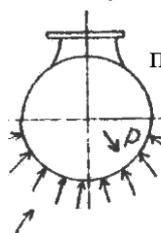
Для этого через верхний люк цистерны опустили трубу, по которой подали насыщенный водяной пар. Когда мазут был полностью слит, трубу из цистерны вынули, а люк немедленно герметически закрыли. Через некоторое время цистерна была смята атмосферным давлением.
