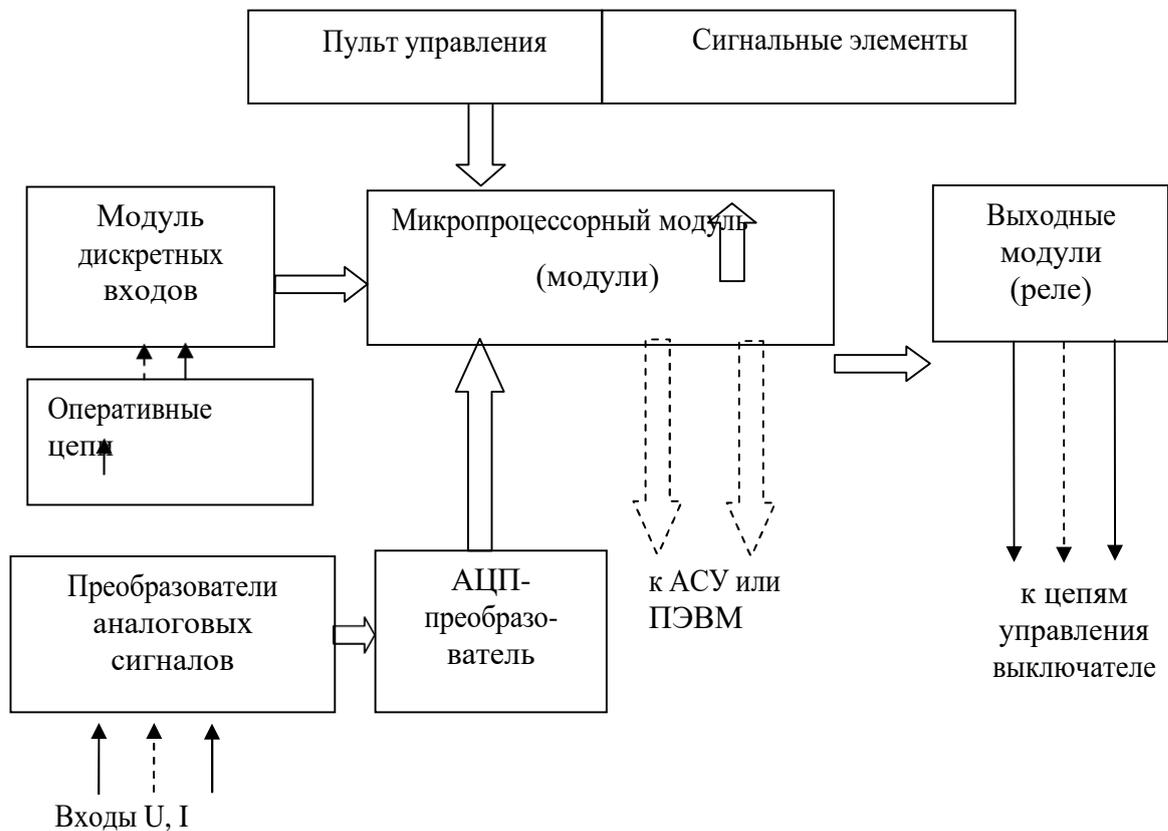
Рисунок 2.1.1. Структурная схема микропроцессорного устройства
