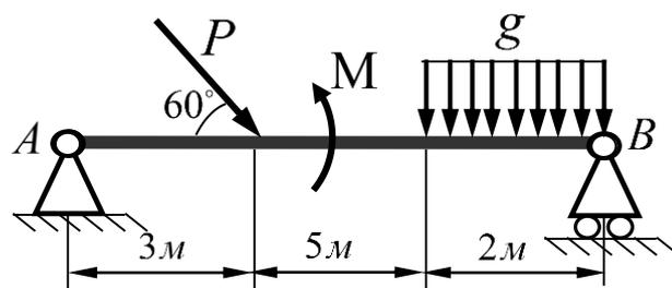
3. Определить реакции опор заданной конструкции, если  $M = 6кН \cdot м$ ,  $F = 3кН$ . Необходимые размеры указаны на рисунке.
