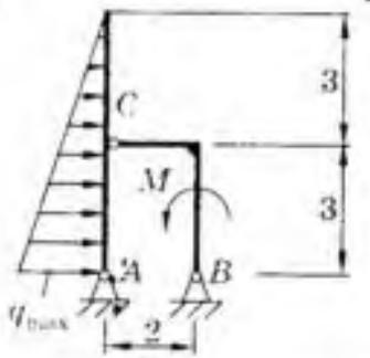
$M = 20 \text{ кН}\cdot\text{м}; q_{\text{max}} = 40 \text{ кН/м}$
