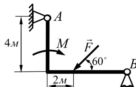
конструкции , если  $M = 10 \text{ кН} \cdot \text{м}$ ,  $F = 5 \text{ кН}$ .
