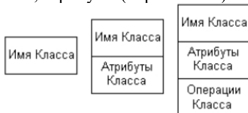
Рис. 1. Графическое изображение класса на диаграмме классов
