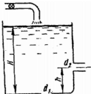
Задача 8. Определить мощность на валу центробежного, подающего воду по трубопроводу длиной  $l = 1400$  м и диаметром  $d = 150$  мм, высота подъема воды  $H_T = 10$  м, свободный мотор  $h_{св} = 15$  м. Коэффициент сопротивления трения трубопровода  $\lambda = 0,025$ .
