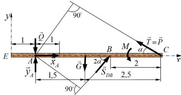
Данная конструкция (балка) под действием активных сил и сил реакций (произвольно плоская система сил) находится в состоянии равновесия. Составляем уравнения (условия) равновесия данной системы сил, с учетом системы координат.
