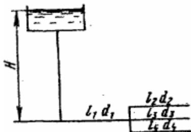
Задача 7. В баке, имеющем в дне отверстие диаметром  $d_1 = 100$  мм и в стенке отверстие, снабженное цилиндрическим насадком, диаметром  $d_2 = 75$  мм; установленлся уровень воды на высоте  $H = 1,8$  м (см. рис.). Определить, какой расход воды  $Q$  поступает в бак, если центр бокового отверстия возвышается над дном бака на высоту  $h = 0,4$  м.
