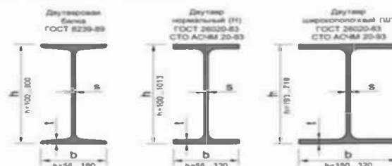
Рис. 1.2 Виды прокатных двутавров, которые используются как балки.
