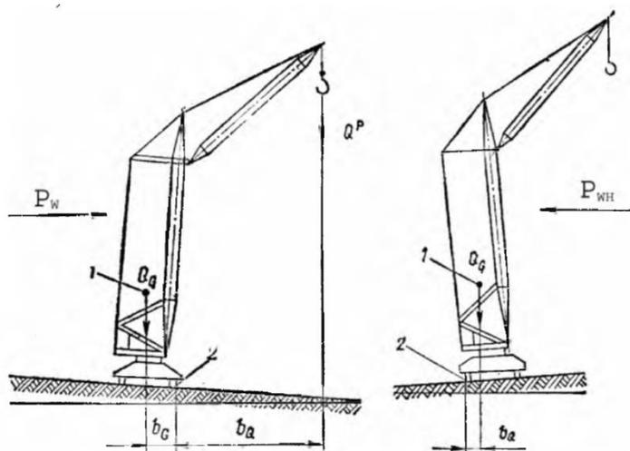
$P_{wи}$   $P_{wн}$ - ветровая нагрузка в рабочем и нерабочем состоянии;
