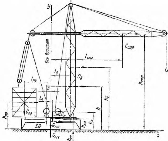
$G_{стр}$ ,  $G_{б}$ ,  $G_{пр}$ ,  $G_{пл}$ ,  $G_{г}$  -вес соответственно стрелы, башни, противовеса, поворотной платформы, лебедки;  $h_{стр}$ ,  $h_{б}$ ,  $h_{пр}$ ,  $h_{пл}$  - высота соответственно стрелы, башни, противовеса, поворотной платформы, лебедки;  $l_{стр}$ ,  $l_{б}$ ,  $l_{пр}$ ,  $l_{пл}$ ,  $l_{г}$  - расстояние от оси вращения до соответственно стрелы, башни, противовеса, поворотной платформы, лебедки
