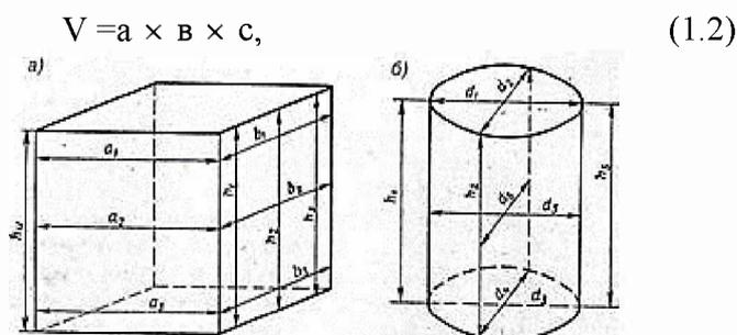
Рис. 1.1. Образец правильной геометрической формы:
