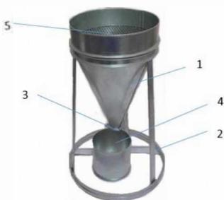
Рис. 1.2. Прибор для определения насыпной плотности материалов: 1 — воронка; 2 — подставка; 3 — задвижка; 4 — мерный цилиндр; 5 — сито
