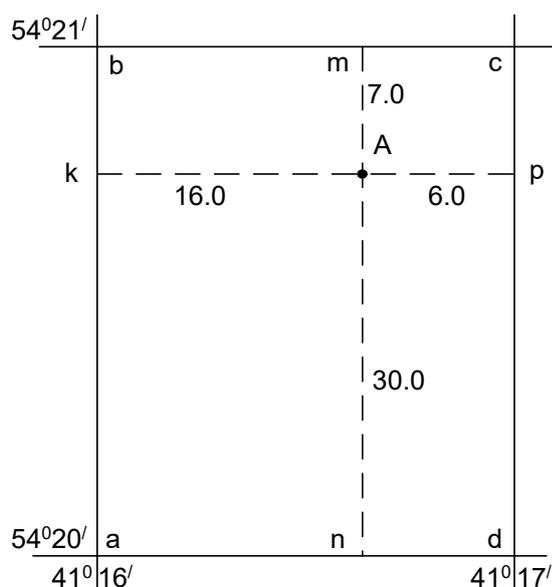
Рис. 1. Определение географических координат точки, данной на карте
