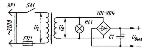
Необходимость преобразования переменного тока в постоянный вызвана тем, что производство и распределение электрической энергии в основном осуществляется на переменном токе. В тоже время многие потребители электрической энергии могут работать только на постоянном токе, а многие имеют на постоянном токе лучшие характеристики и параметры.
