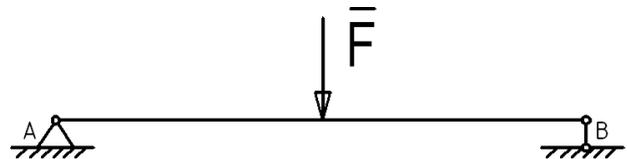
**8. Реакции опор  $R_a$  и  $R_b$  в данной балке:**
